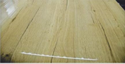
Für die Flächenbeschichtung oder Ummantelung von Holzwerkstoffen gefertigte Uni- und Dekorfolien von 50 bis 130 g Basisgewicht.
