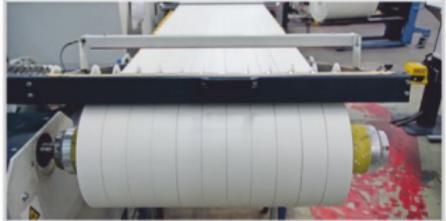
Finishfolien, Grundierkanten und Kantenmaterialien werden auf Trägermaterialien in Stärken von bis zu 1,0 mm dubliert.
