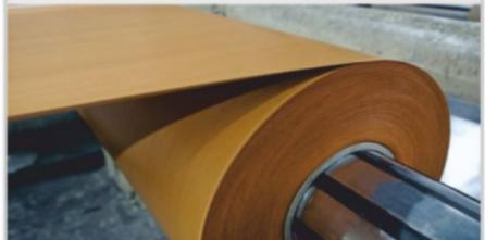
Natronkraftpapier imprägniert mit Phenolharz für die CPL - Produktion und Melaminfilme für CPL zur Verarbeitung auf Kurztaktpressen.
